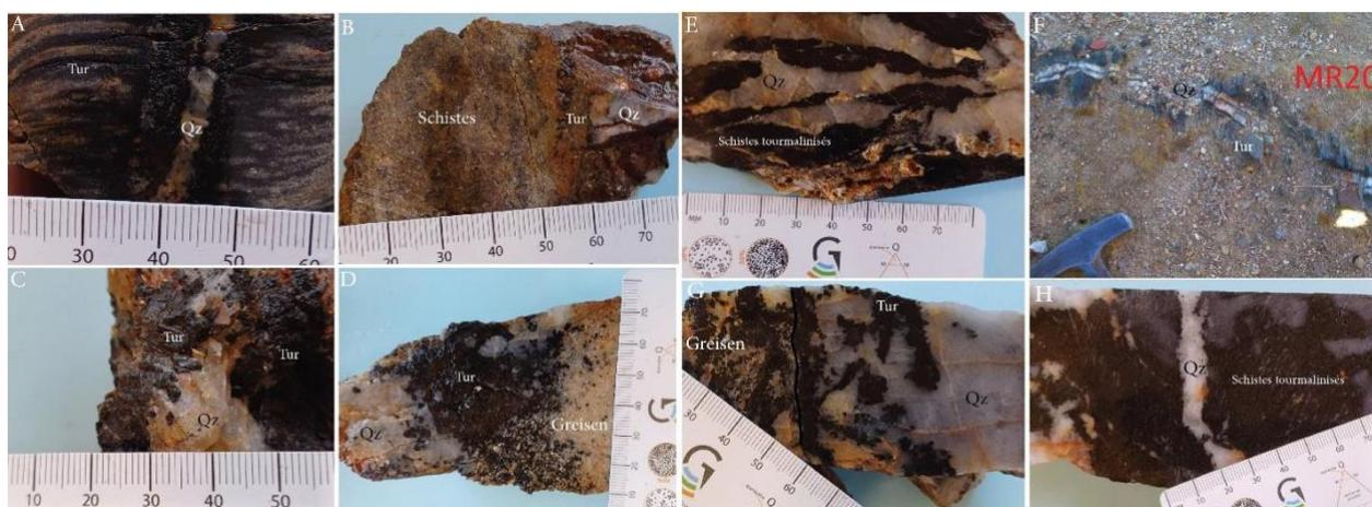
Figure 4 : Planches photographiques montrant les échantillons dans la zone d'étude : A) schistes fortement tourmalinisés de part et d'autre de la veine de quartz ; B) zone de contact entre les schistes et le quartz ; C) grains de tourmaline automorphe et quartz au contact avec le greisen ; D) contact quartz-tourmaline et greisen ; E) veine de quartz dans des schistes tourmalinisés ; F) tourmalinite et quartz ; G) veine de quartz-tourmaline. Qz = Quartz ; Tur = Tourmaline.
